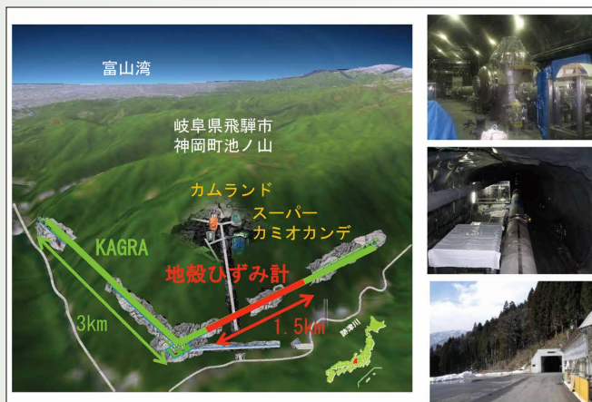
図1 重力波望遠鏡 KAGRA (緑線) と地殻ひずみ計 (赤線)。(宇宙線研究所資料を改変)
