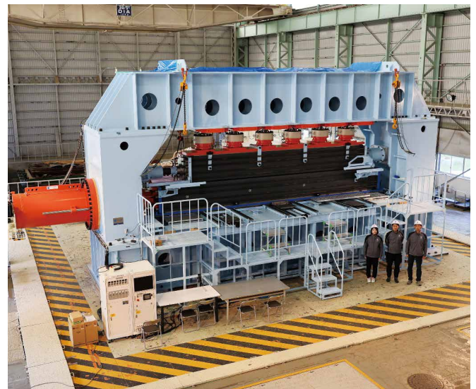
図4 新たに開発した巨大岩石摩擦試験機の外観 3 。2023年完成。断層面の長さ6m、幅0.5mで、最大1mすべらせることが可能。大型振動台は利用せず試験機に取りつけた大型ジャッキで力を加え断層をすべさせます。
