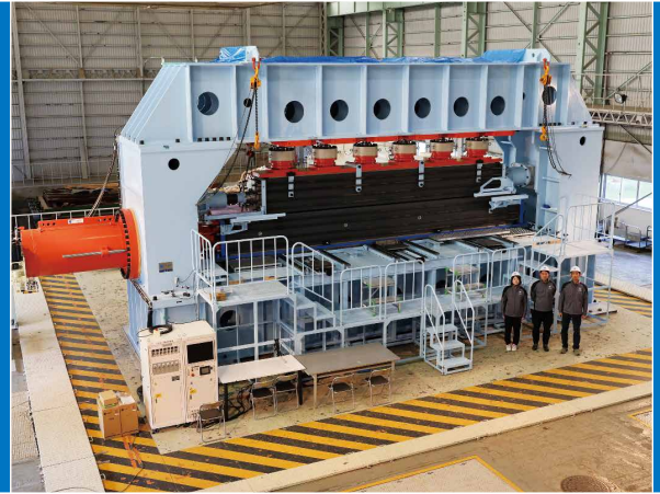
2023年に完成した巨大岩石摩擦試験機。詳しくは4-5ページをご覧ください。▲
